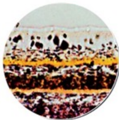
EMULSION TOUCHÉE PAR LA LUMIÈRE AVANT DÉVELOPPEMENT
