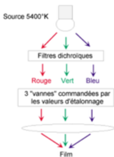
TRAJET DE LA LUMIÈRE À TRAVERS LES FILTRES DICHROÏQUES
